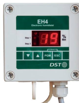
EH4 och standard rumssensor, IP 65. Rumssensor: RJ9 lågspänningskabel, 3 m. Tillägs-kit: 25 meters RJ9 kablar (max 50m)
